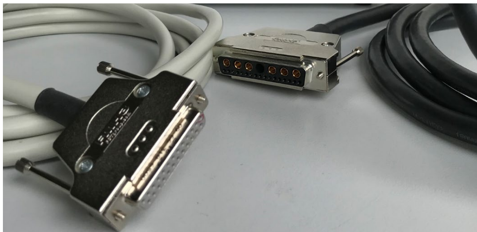
Fig. 7 Câbles et raccords pour la connexion du module PCR au contrôleur.
