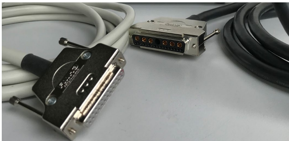
Abb. 7 Kabel und Anschlüsse für die Verbindung des PCR-Moduls mit dem Controller.
